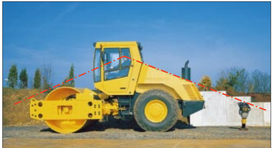
Die exzellente Übersicht (1m-x-1m-Regelung) bedeutet mehr Sicherheit auf der Baustelle.
