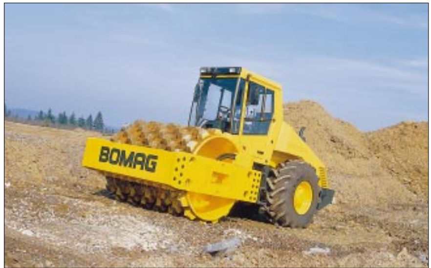
Walzenzüge mit Stampffußbandage für bindiges Einbaumaterial
