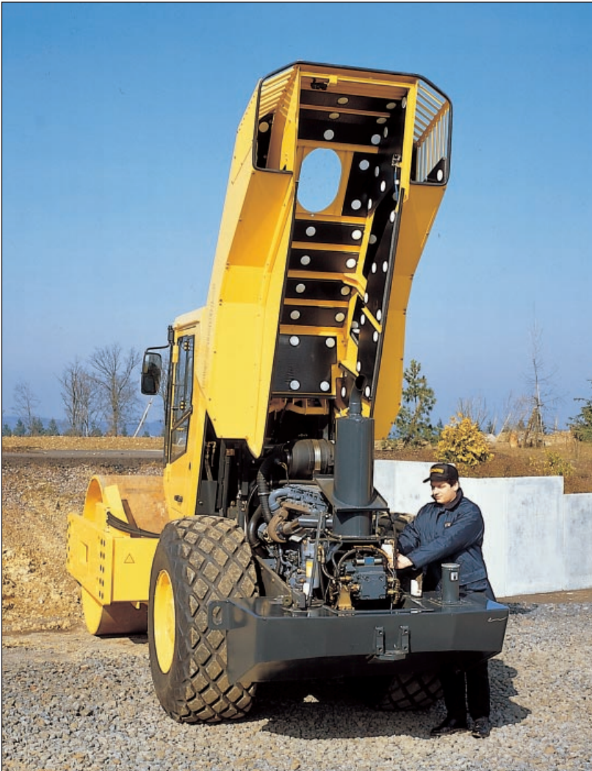
Hydraulisch voll hochklappbare Motorhaube für freien und bequemen Zugang zu allen Service- und Wartungsstellen am Antriebsaggregat
