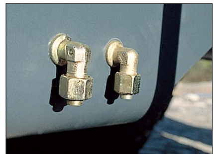
Reduzierter Zeitaufwand, umweltschonend – zentrale Ablassanschlüsse für Motor-, Hydrauliköl und Kühlwasser
