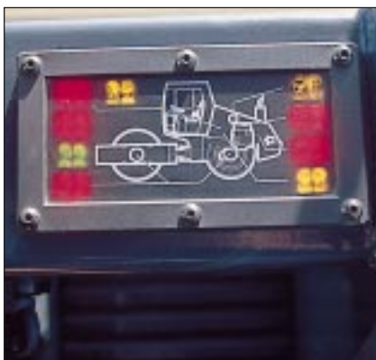
Gezielten Aufschluß über den Betriebszustand gibt die Funktionsüberwachungsanzeige
