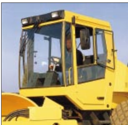
ROPS/FOPS-Kabine mit zwei Außenspiegeln und Arbeitsbeleuchtung
