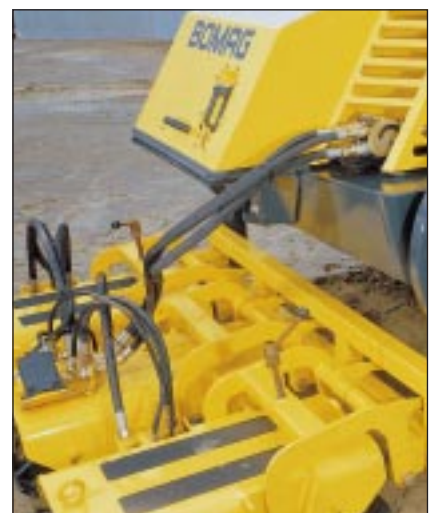
Walzenzug in Verbindung mit Vibrationsplatten
