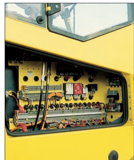
Gut zugängliche Zentralelektrik in Modultechnik
