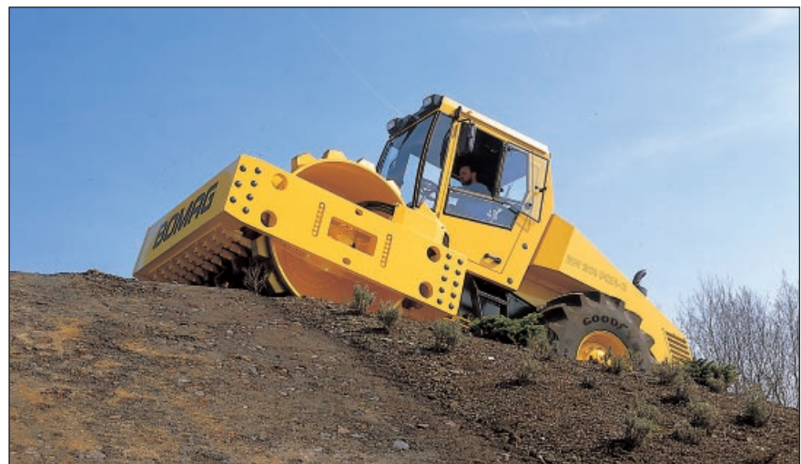
Einsatz im Deponiebau mit Steigungen über 50 %, auch für schwerste Walzenzüge bis 19 to.
