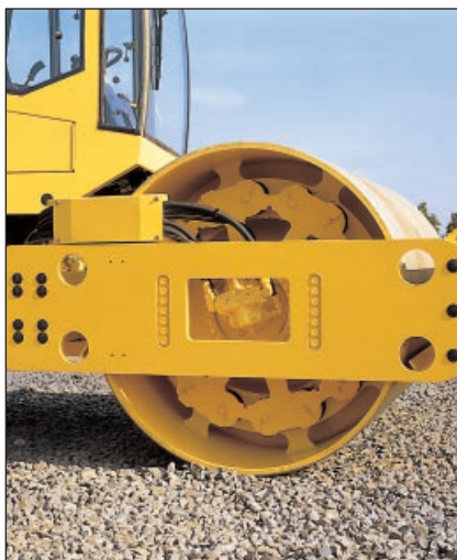
Der verstärkte Bandagenantrieb ist vollständig in der Bandage integriert.
