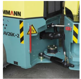
lebensdauergeschmiertes Teflon- Pendelgelenk
