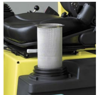
Wasser-Mehrfachfilterung und einfach zugängliche Berieselungsdüsen
