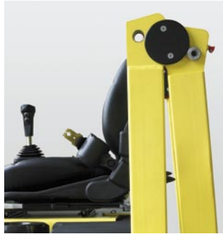
Klappbarer ROPS für einfachen Transport
